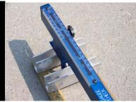
\*THE DISTANCE BETWEEN GUARD LINES, MEASURED ACROSS THE TRACK AT RIGHT ANGLES TO THE GAUGE LINE.
